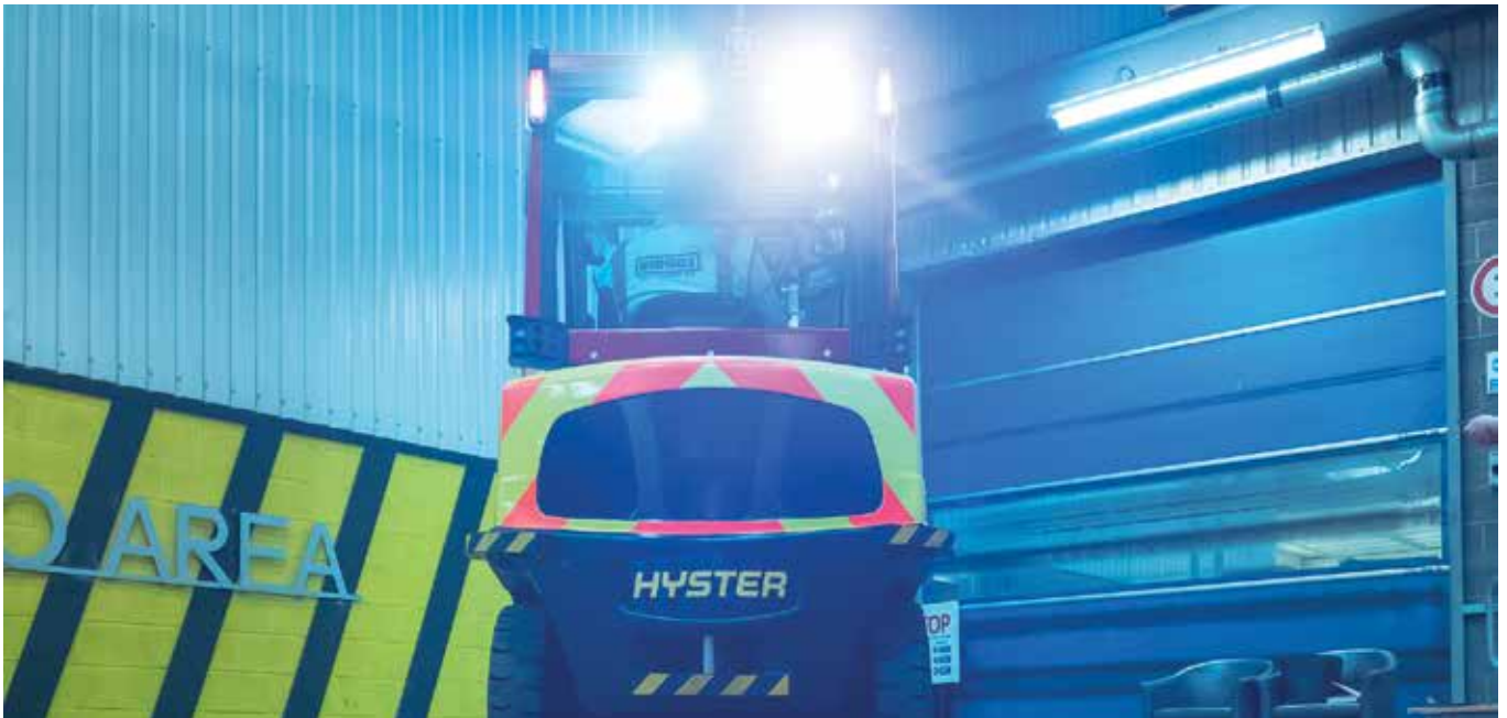
Los focos delanteros y traseros se activan automáticamente cuando la carretilla se mueve (Copyright Hyster Europe).
